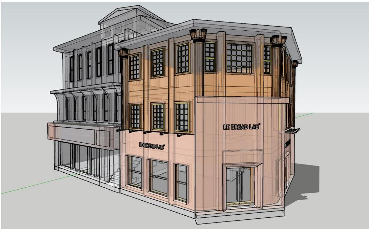
자혜의원 3D Scanning을 통한 Point Cloud 기반 3D 역설계 모델링
